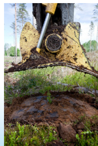
P11.0 производит высадку на одинаковую глубину в середину холмика, что обеспечивает максимальный прирост и высокий коэффициент выживания саженцев.
